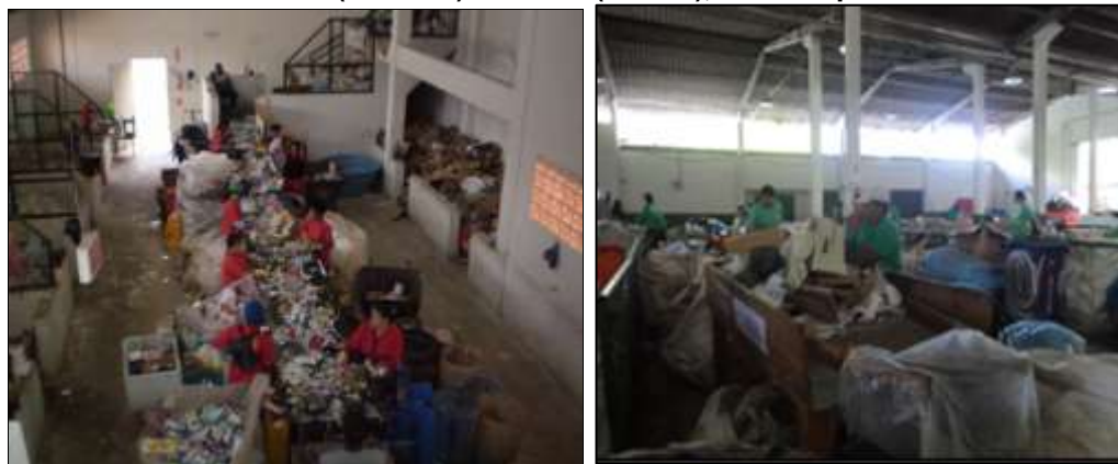
Figura 15: Triagem manual utilizando esteira transportadora e mesas. Da esquerda para direita: ARESP (esteiras) e ACMR (mesas), Florianópolis.
