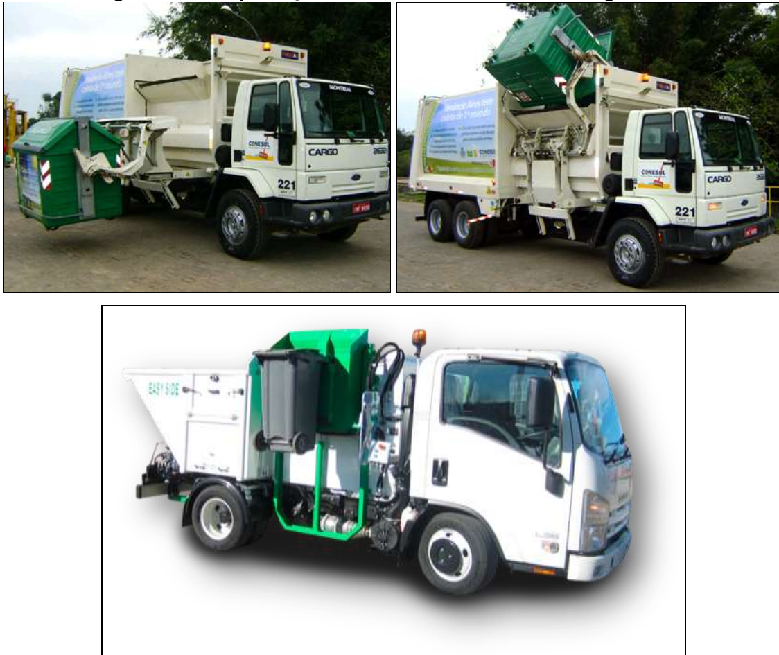
Figura 11: Exemplificação da coleta containerizada de carga lateral.
