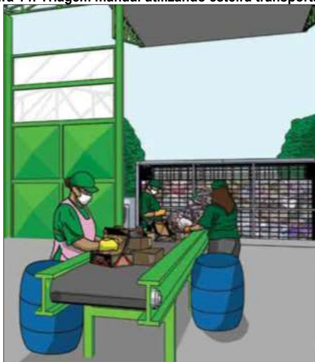
Figura 14: Triagem manual utilizando esteira transportadora.
